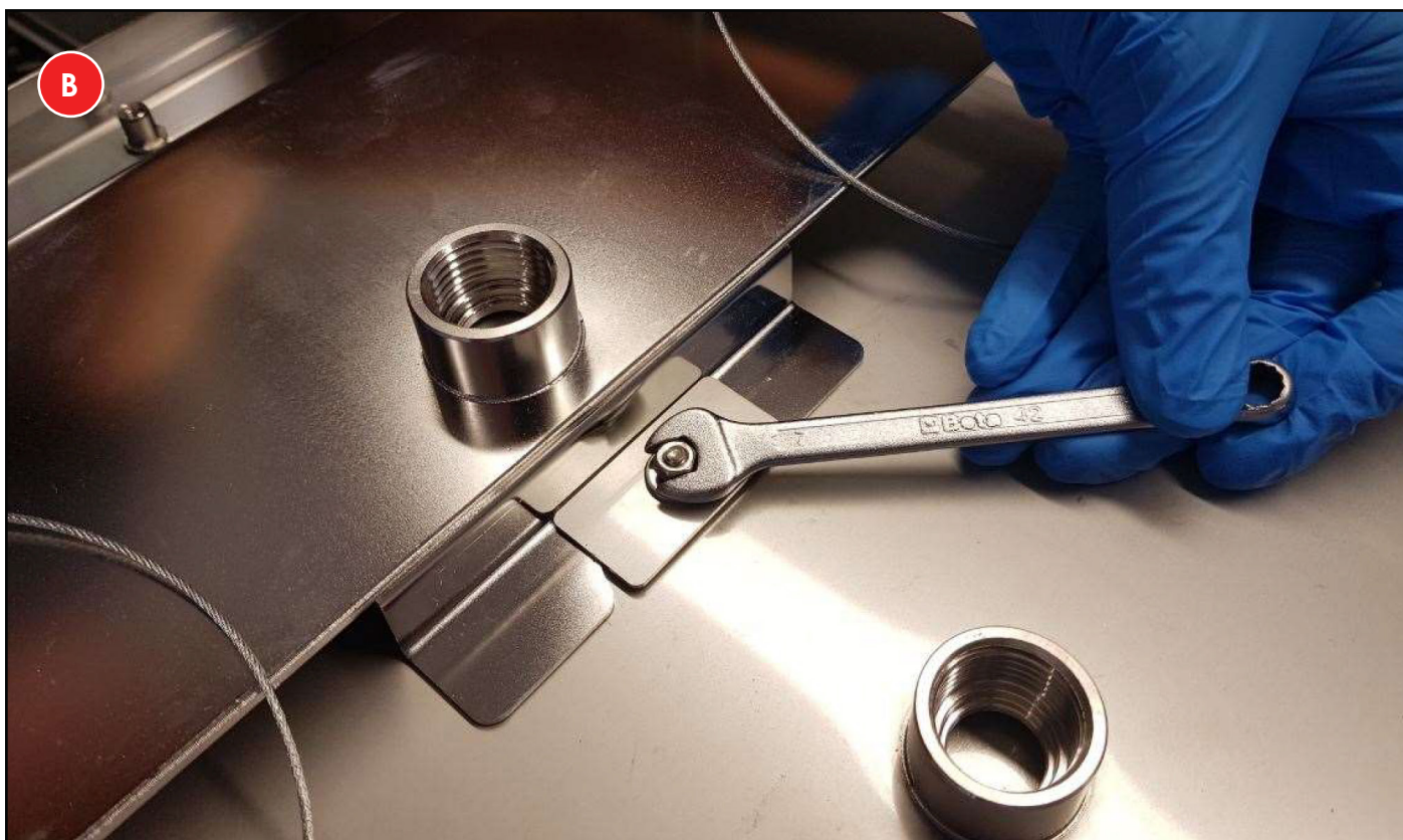
B Svitare i dadi di fissaggio delle cascate (n°3 dadi per ciascuna cascata, con relative rondelle). In foto il dado centrale. Unscrew the waterfalls fixing nuts (n°3 nuts for each waterfall, with relative washers). In the picture the central nut.
